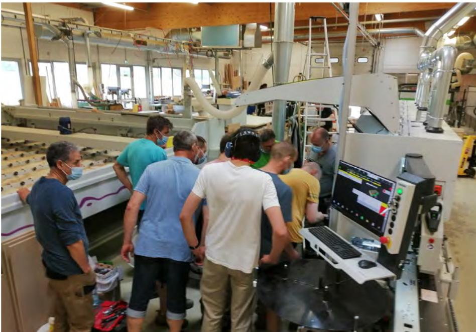
Ces deux nouvelles acquisitions s'ajoutent à notre centre d'usinage 5 axes. Ces équipements à commande numérique sont interconnectés entre eux. Ce processus facilite le travail des opérateurs. L'acquisition également d'un préhenseur sur potence permet une assistance mécanique au déplacement des panneaux.
